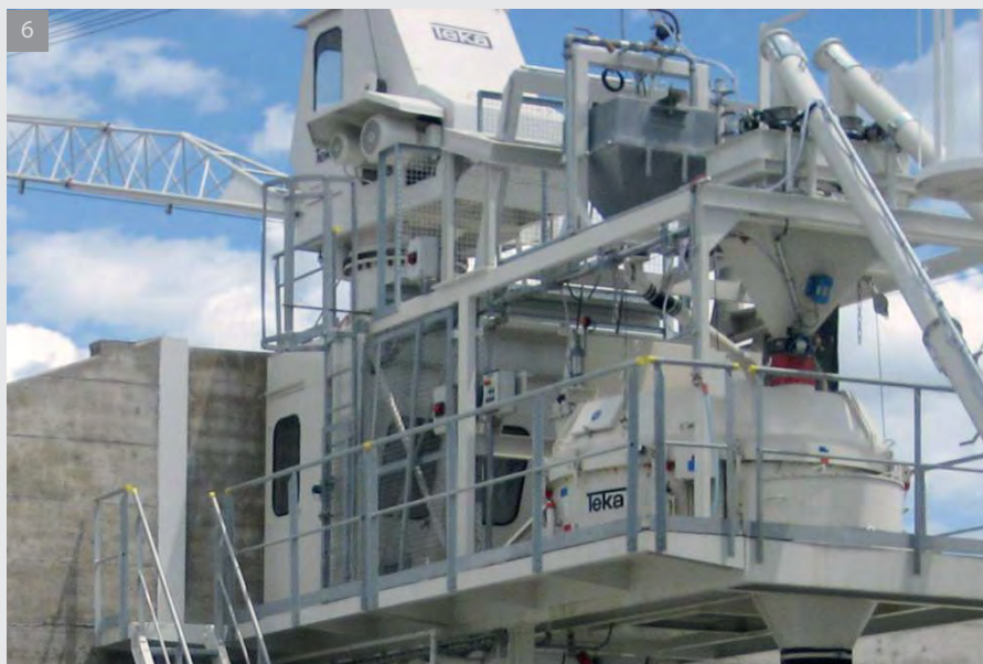
6 | TRANSMIX THZ 1500 - S 5 установка с радиальным складом и автоматическим скреперным механизмом THS 40/20
