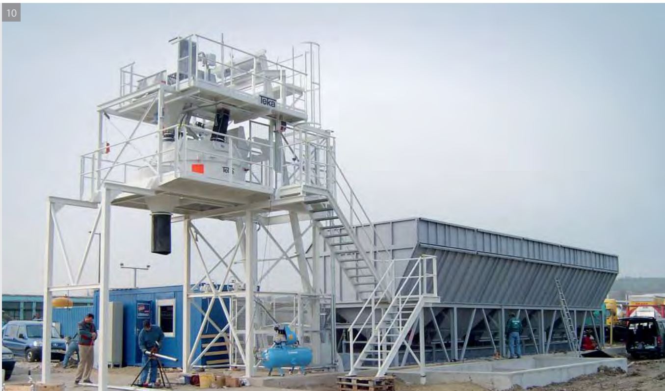
10 | TRANSMIX THZ 1500 - R 5 с линейным складом, 5 камер
