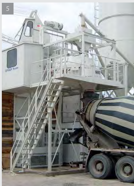
5 | TRANSMIX THZ 750 - S 4 установка с радиальным складом и ручным скреперным механизмом TS 12/13
