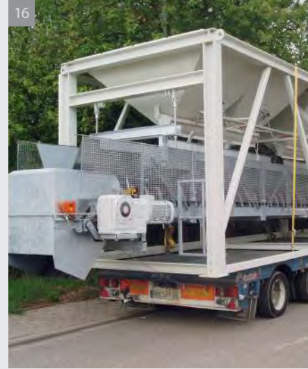
14-16 | Транспортировка модулей MIXOMAT THZ 3000-R 4/4 с нижней частью линейного бункера, весовой и смесительной платформами.
