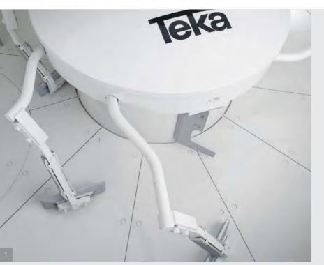
3 | Тарельчатые смесители с ТНZ 250 по THZ 1125 приводятся в действие единым центрально расположенным планетарным редуктором с фланцевым двигателем.
