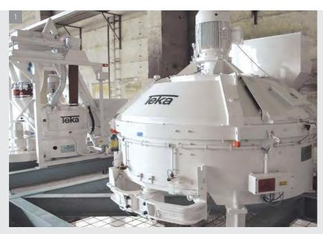
1 | ТНТ смеситель отлично подходит для облицовочных, фибро-, пено-, самоуплотняющихся, цветных, особо высокопрочных и т.д. бетонов. Кроме того турбинный смеситель идеально подходит для использования при абсолютно минимальных порциях смеси, что обеспечивает ему уникальную гибкость.
