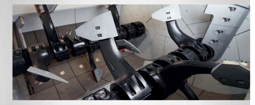
Для различных областей применения и высокой производительности при производстве типовых смесей, товарного бетона, бетона на строительной плащадке, раствора и. д.
