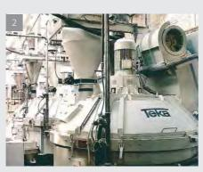
4 | Система выгрузки: отдельная гидростанция для работы ротационно-поршневого цилиндра (исключение составляет смеситель ТРZ250 с электроприводом системы выгрузки); ручной насос аварийной выгрузки смесителя; позиционирование разгрузочного шибера для любого частичного раскрытия разгрузочного отверстия; большой размер разгрузочного отверстия для быстрой
