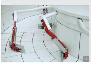
2 | Централизованная смазка втулок месильных рычагов возможно в специально
