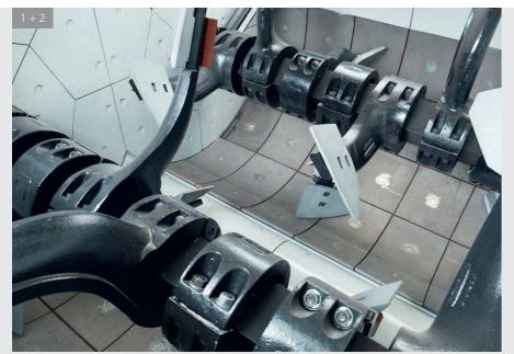
1 | Смесительный лоток серийно защищен от износа футеровочной плиткой из высококачественного отбеленного чугуна. Боковые и торцевые стенки также защищены от износа сменной футеровкой.
