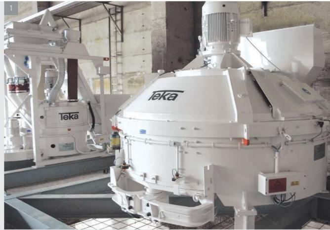
1 | ТНТ смеситель отлично подходит для облицовочных, фибро-, пено-, самоуплотняющихся, цветных, особо высокопрочных и т.д. бетонов. Кроме того турбинный смеситель идеально подходит для использования при абсолютно минимальных порциях смеси, что обеспечивает ему уникальную гибкость.
