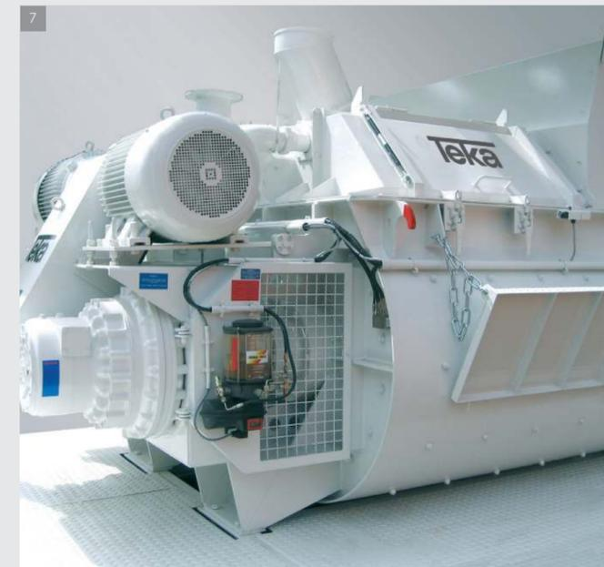
Непосредственно на смесительном лотке смонтирован пыленепроницаемый защитный кожух. Загрузочные проемы для материалов расположены в промежутке между месильными валами. В защитном кожухе с обеих сторон предусмотрены широкоформатные откидные крышки, обеспечивающие беспрепятственное выполнение очистных и сервисных работ.
