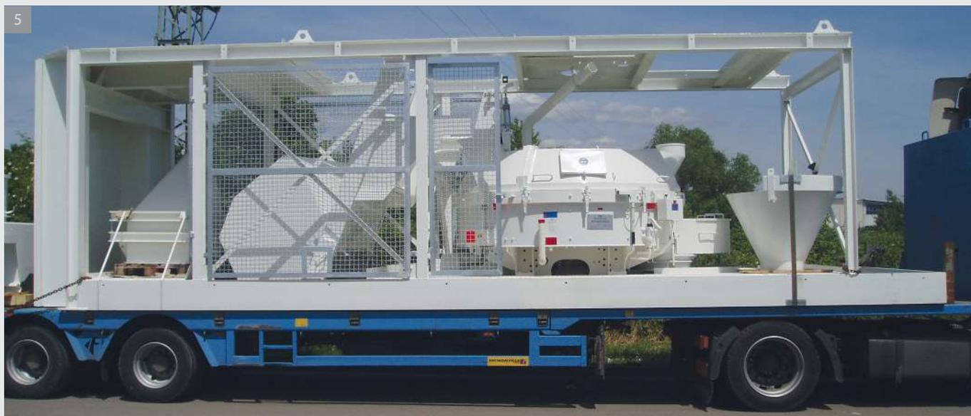
5 | Транспортировка MIXOMAT THZ 1500 B - S5, установка с радиальным складом и ТЕКА высокопроизводительным тарельчатым смесителем с принадлежностями.
